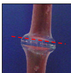
Не тянуть за трубку. Следует отрезать ее по шву (пунктирной линии)
